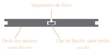
La tabla no se debe atornillar directamente, para permitir su correcta expansión y contracción. Se debe separar 5mm de cualquier borde o de otras tablas.
